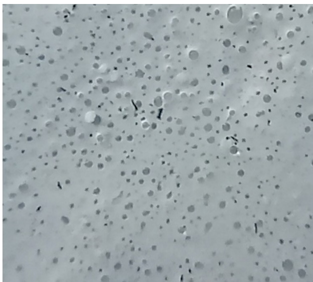
Obrázek 20 – Příklad NESPRÁVNÉHO zabudování – utopená zrna balotiny
