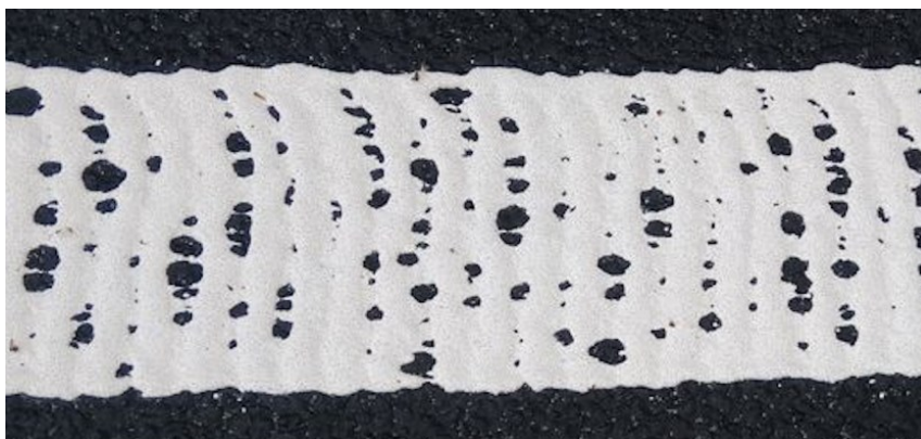
Obrázek 6 – NESPRÁVNÉ provedení strukturální značení (nedostatečná makrotextura a mezerovitost VDZ)
