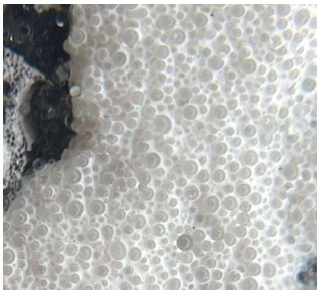
Obrázek 19 – Příklad optimálního zabudování balotiny do hmoty
